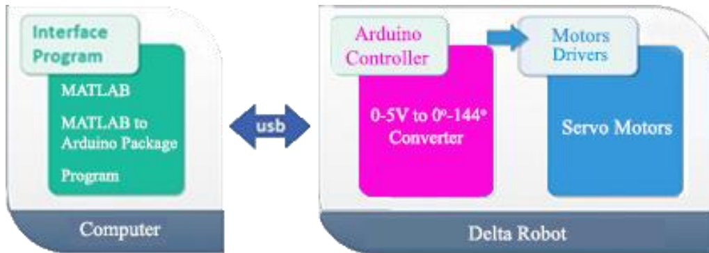
Şekil 2. Delta robot tabanlı kaotik karıştırıcının blok diyagramı
